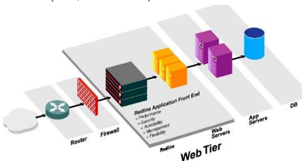
Rys. 3 - Architektura datacenter z wykorzystaniem platformy AFE
